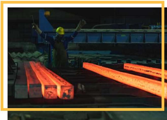
Siderúrgica Zuliana, con un proceso productivo semi-integrado, utiliza chatarra ferrosa como materia prima, junto con ferroaleaciones, coque y cal. El proceso inicia con la fusión de la chatarra en un **Horno Eléctrico de Arco (HEA)**, seguido de un tratamiento en horno cuchara para el ajuste de composición mediante aditivos. Posteriormente, el acero líquido se vierte en la **Máquina de Colada Continua**, donde se solidifica en palanquillas mediante distribuidores automatizados.
